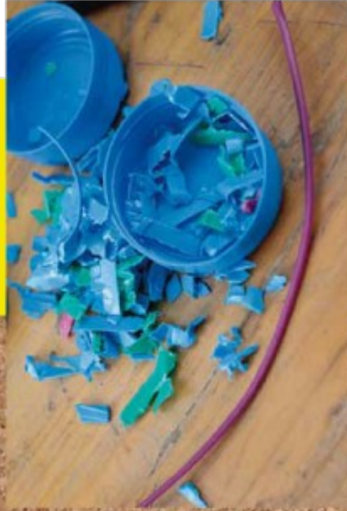
Les bouchons des bouteilles de lait et d'eau sont broyés pour obtenir un film plastique.
